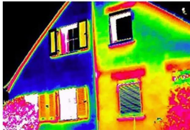
Fassade gedämmt | ungedämmt
